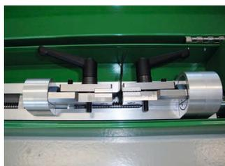
Apparecchio prova tensione TestOn per il controllo con una semplice operazione delle saldature. La precisione anche in cantiere.
