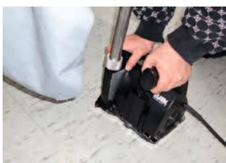
L'apparecchio affidabile per la fresatura, senza polvere, di qualsiasi tipo di pavimento resiliente.
