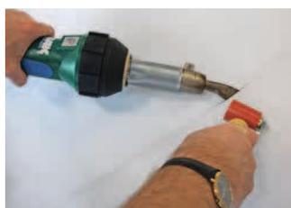
L'apparecchio manuale per la saldatura di materiali termoplastici per guaine impermeabilizzanti, pavimenti, teloni, lavorazioni plastiche.
