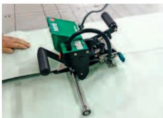
La piccola e leggera saldatrice a cuneo caldo per la prefabbricazione di materiale sottile. Saldature perfette con elevata velocità di saldatura. La posizione della macchina è nota con l'app myBAK
