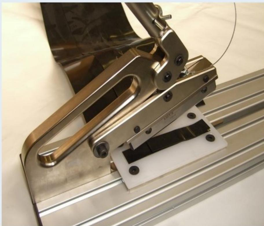
Il dispositivo Coupon Cutter taglia in maniera precisa ed efficace i campioni di saldatura da testare alla prova di peeling con il nostro apparecchio di prova modello Teston, con dimensioni e forma come indicato dalle normative DVS 2225 parte 4.
