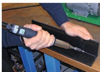
Il piccolo apparecchio manuale per la saldatura di materiali termoplastici per l'industria della lavorazione delle materie plastiche.
