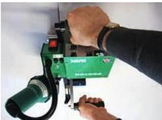
Il più piccolo e leggero carrello automatico per saldare diversi tipi di materiali. Per ingegneria civile e isolamento di gallerie. Motore di avanzamento e riscaldamento senza spazzole. Saldatura combinata aria calda e contatto.
