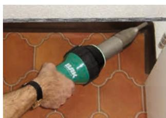
Temperatura regolabile in continuo sino a 650°C. Potente, con impugnatura ergonomica per le più svariate applicazioni ed con una vasta gamma di accessori come ugelli, riflettori ecc.
