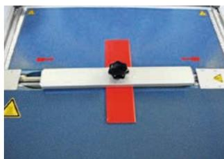
Mini barre riscaldanti per la piegatura di piccoli display o lastre e film termoplastici.
