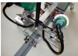
Per la saldatura di profili termoplastici in una sola operazione. Economico e pratico, alta velocità di saldatura, testato sul campo.
